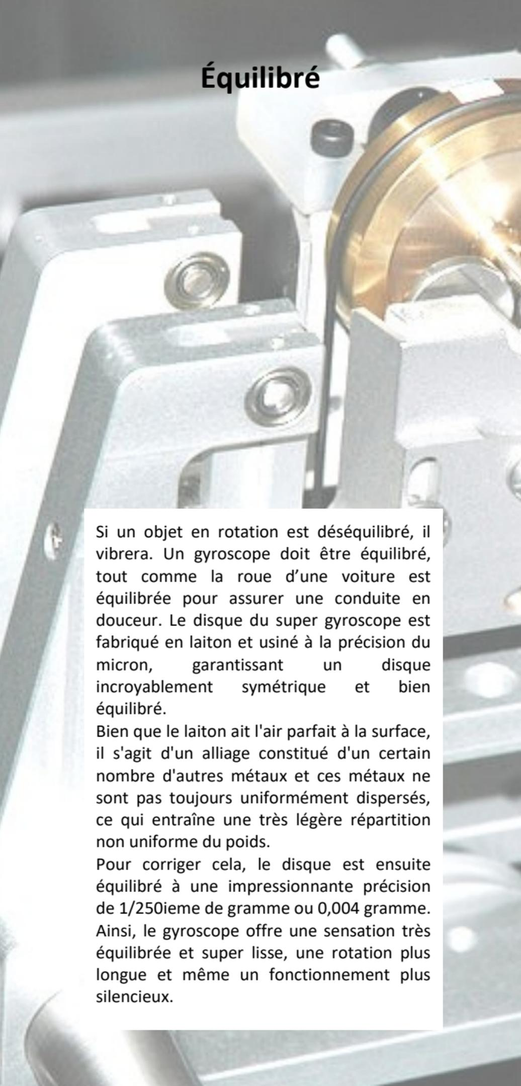
Si un objet en rotation est déséquilibré, il vibrera. Un gyroscope doit être équilibré, tout comme la roue d'une voiture est équilibrée pour assurer une conduite en douceur. Le disque du super gyroscope est fabriqué en laiton et usiné à la précision du micron, garantissant un disque incroyablement symétrique et bien équilibré.
