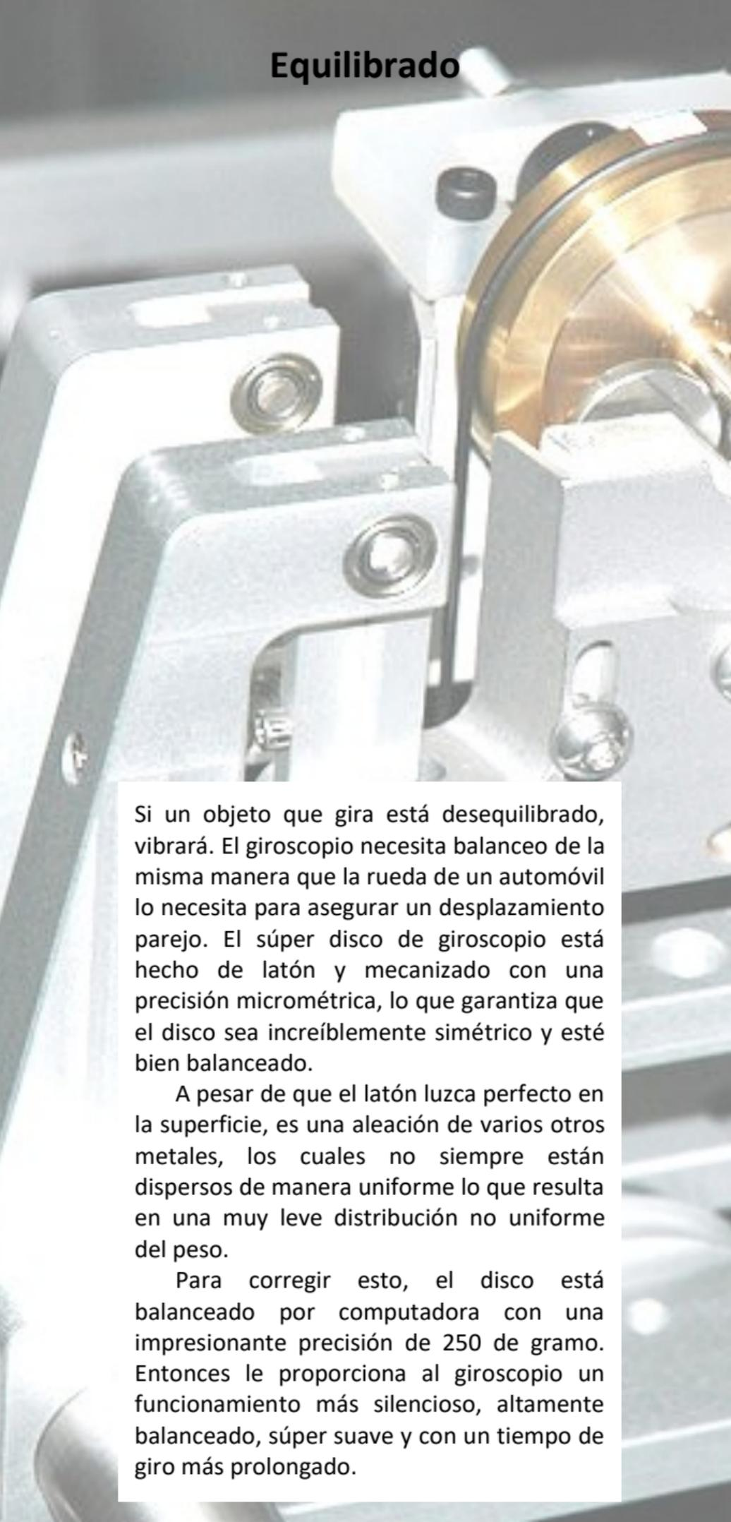
Si un objeto que gira está desequilibrado, vibrará. El giroscopio necesita balanceo de la misma manera que la rueda de un automóvil lo necesita para asegurar un desplazamiento parejo. El súper disco de giroscopio está hecho de latón y mecanizado con una precisión micrométrica, lo que garantiza que el disco sea increíblemente simétrico y esté bien balanceado.
